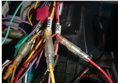
ナビブースター本体の赤、黄のオスキボシ端子を車両側のACC(赤)車両側の常時電源(黄)のメスキボシ端子に接続する。
