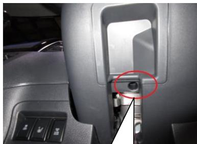
ハンドルコラム下から覗くと、チルトレバー手前(赤丸の位置)にコラムカバー固定ネジがあります。ネジを外してカバーの下側を引っ張るとコラムカバーが外れます。
